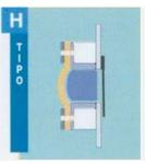
Temperatura °C 350 a 1.200 0 a +2.000 Presión -2.000 a 0 Depresión **MOVIMIENTO Axial** Lateral 25% ± 15%
