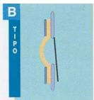
Temperatura °C -60 a +450 Presión 0 a +10.000 Depresión **MOVIMIENTO Axial** Lateral ± 15%
