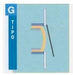
Temperatura °C -60 a +500 Presión -5.000 a 0 Depresión **MOVIMIENTO Axial** Lateral
